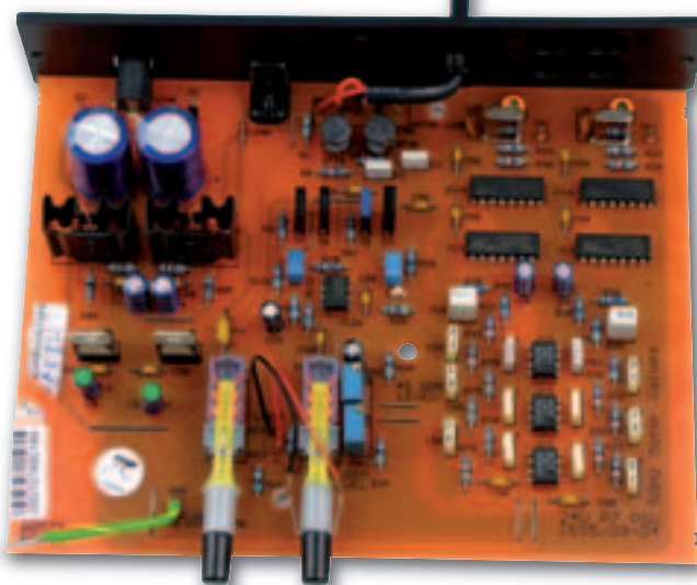
Die Motorsteuerung TTPSU glänzt mit zwei Quarzgeneratoren für 33 1/3 und 45 Umdrehungen und recht kräftigen Class-A-Endstufen.
